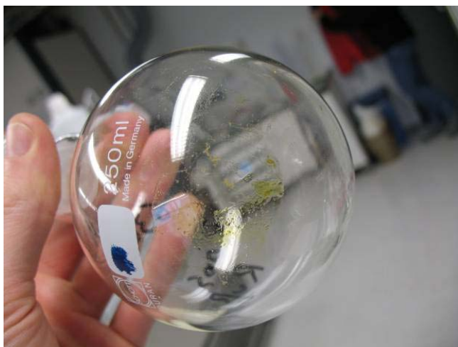
Abbildung 3: Extraktionsrückstand im 250 mL Rundkolben nach dem Abblasen des Dichlormethans
